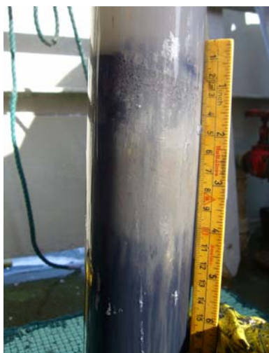
Figur 5 Kjerneprøve fra punkt 3, viser lagdeling med ca 2 cm re-sedimentert materiale, 6 cm leire og forurenset sediment under.
