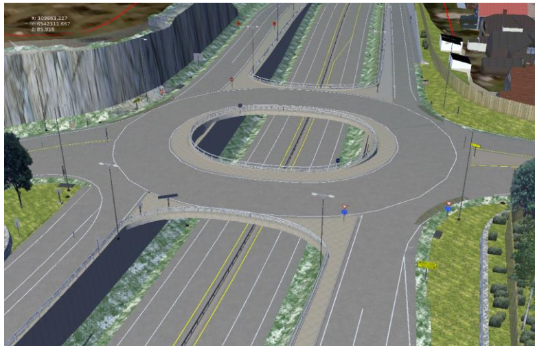
Figur 3-4 Eksempel på brurekkverk ved rundkjøring
