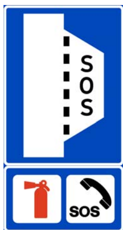
Figur 3.19 Skilt 555 med serviceskilt 600.21H
