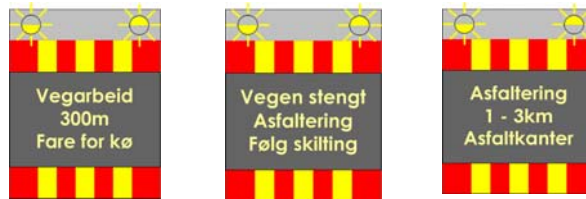
Figur 3. 8: Eksempler på skilt 560 på varselpanel
