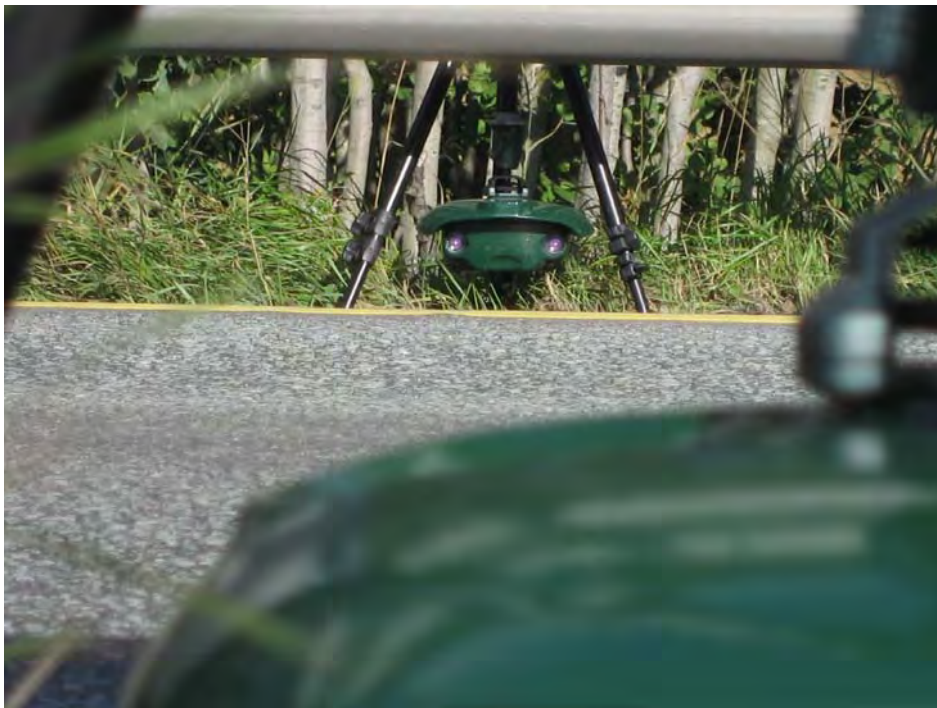
Figur 4.15 Registreringsenhet som sender ut infrarødt lys
