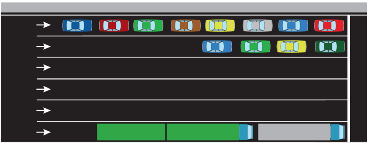
Figur 10.5 Eksempel på oppmerking på ferjekaier
