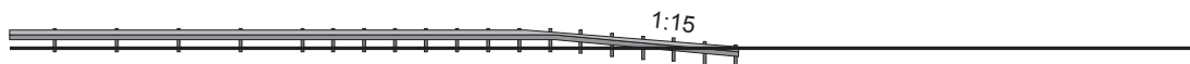
Figur 4.11: Eksempel på forankring av rekkverk med nedføring på veg med fartsgrense 50 og 60 km/t
