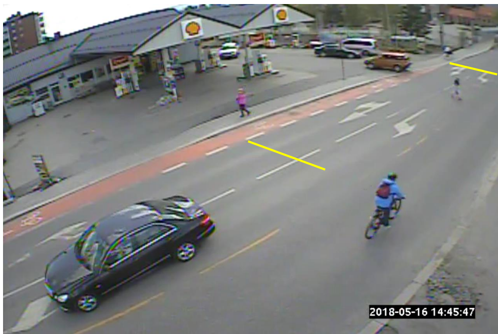
Figur 4. Bilde fra videokameraet med plassering vest (før oppmerking med sharrows). Gule linjer angir referanselinjer for måling av syklistenes fart. Linjene ble lagt på skjermen under avlesning og var ikke avmerket i vegbanen.
