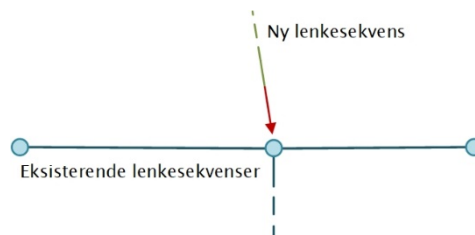
Figur 8: Tilkobling av ny veg til eksisterende T-kryss.
