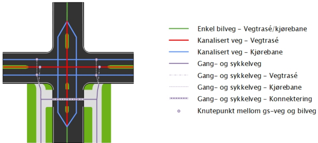
Figur 35: Nivådeling av gs-veg mot kjøreveg.
