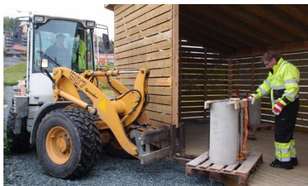
Utplassering av sylindre på Moholt feltstasjon. Ubehandlede store sylindre som skal stå beskyttet mot nedbør. Foto: Ola Skjølvold, SINTEF
