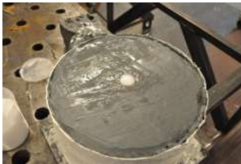
b) Saltbrønn fylt med tjukk saltslurry
