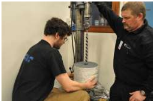
a) Saltbrønn blir skjært ut i blokkprøven
