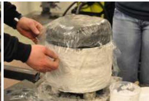
c) Forsegling og voksing av prøven
