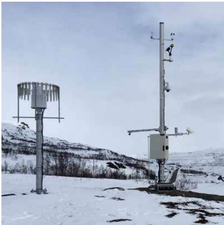
Figur 6: Værstasjon med både optisk nedbørsmåler og nedbørsmåler på bakkenivå
