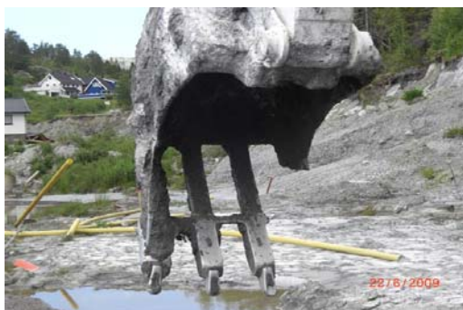
Figur 6: "Gaffelgrabb" brukt for overflate innblanding av kalk
