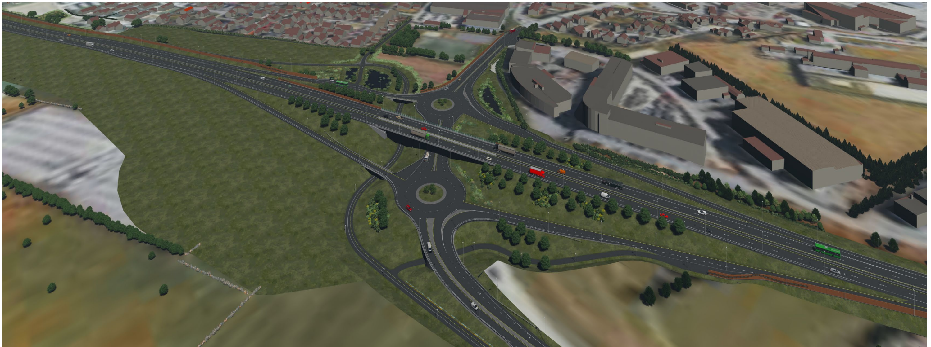
Figur 32. Finnestadkrysset med to rundkjøringer som knytter av- og påkjøringsramper til lokalvegnettet. Nederst vises rundkjøring som kobler på transportkorridor vest.
