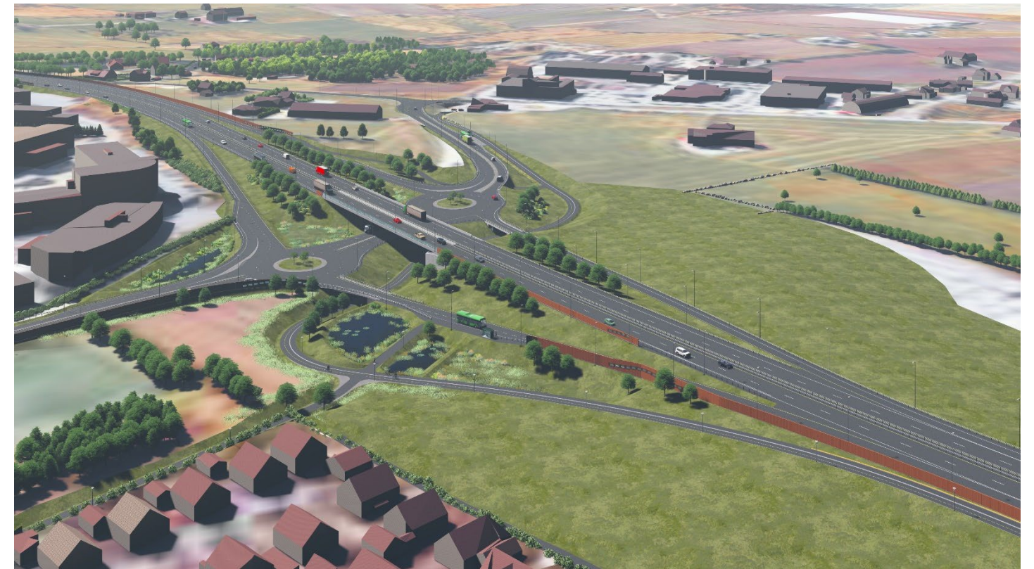
Figur 34. Illustrasjon fra 3D-modell viser Finnestadkrysset sett mot sørvest. Her vises de tre våte fordrøyingsbassengene og et tørt (bakerst) med grønnere farge.
