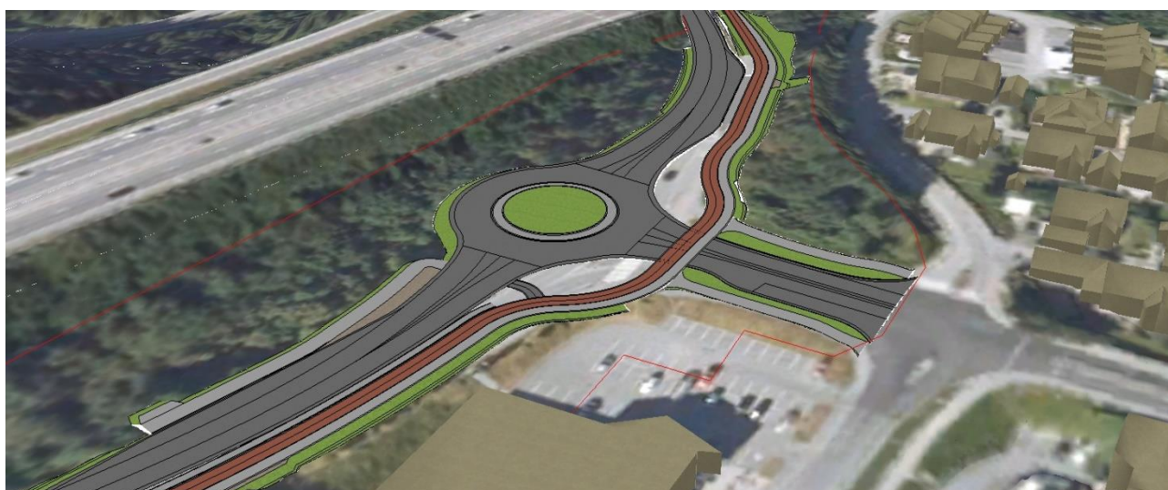
Figur 5-8 Illustrasjon av ny rundkjøring ved Gamle Okstadbakkan x Fossestuvegen og holdeplasspar Leirfossvegen
