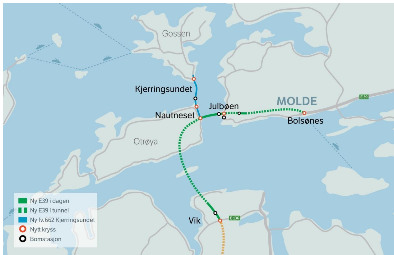
Figur 3. Bomstasjoner for E39 Ålesund-Molde, trinn 1 Vik-Molde. Også vist foreslått bomstasjon for fv. 662. Kjerringsundet.
