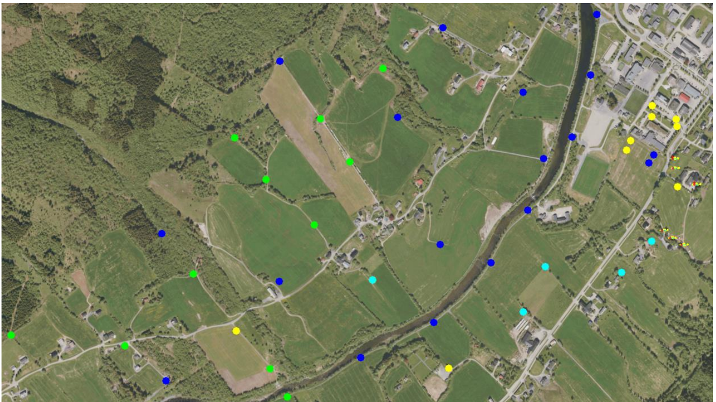
Figur 4-13 Borepunkter med tolking av løsmassekarakteristikk, sør for sentrum
