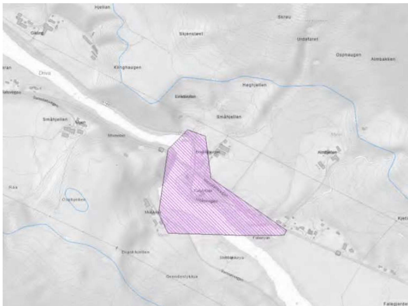
Figur 23. Utsnitt fra NVE temakart kvikkleiresoner. Blå linje angir marin grense, mens skravert område er SVV kvikkleireområde.
