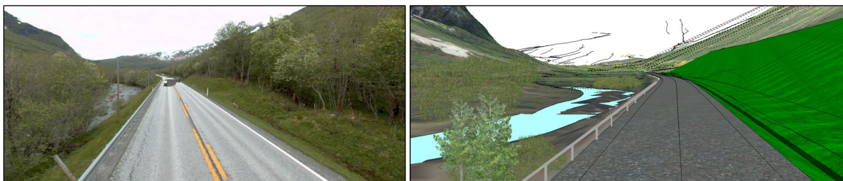
Figur 32 . Skorgeelva går inntil vegen på sørside, og området mot elva skal ikke berøres. Vegrekkverk skal beholdes. Skredvullen vil ligge inntil nordside av E136. Krattvegetasjonen vil reetableres utenfor kantslått-området til vegen, ca. 6-7 m. Det vil ta noen år, men området skal tilsåes. Mindre planter kan flyttes inn for å få raskere etablering på vollen.
