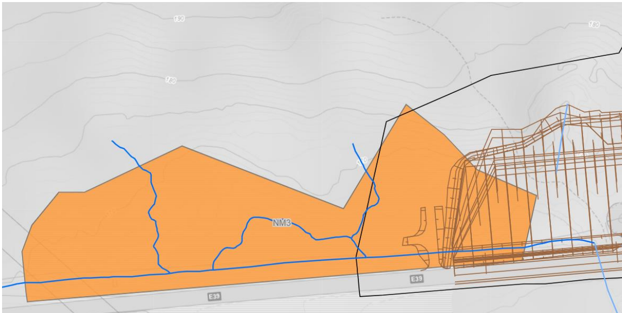
Figur 19. Utklipp fra Arcgis som viser inngrep i delområde NM3 Bøndergjerde. Blå streker er vannveier og svart tykk strek er plangrensen. Anleggs grensen er ikke inntegnet, men vil ligge så nært inntil tiltaket som mulig for å redusere inngrepene.
