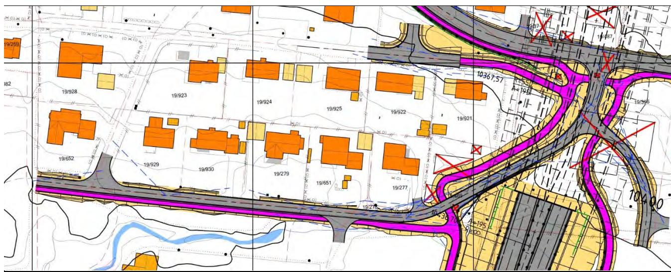
Figur 33 – Forlenging av Nytunvegen og tilkomst til område T1 på vestsida og T5 på austsida av ny E39.
