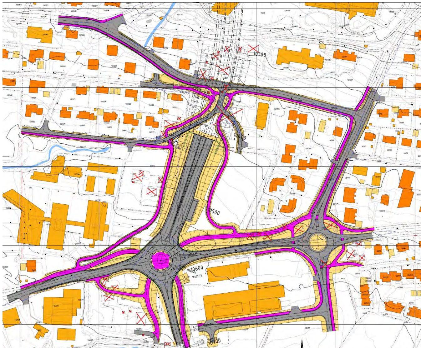
Figur 26 – Oversiktssillasjon, ny situasjon i Volda. Fjellpåhogget vil kome ved pel ca. 10310. Overdekt betongtunnel fram til profil 10415.
