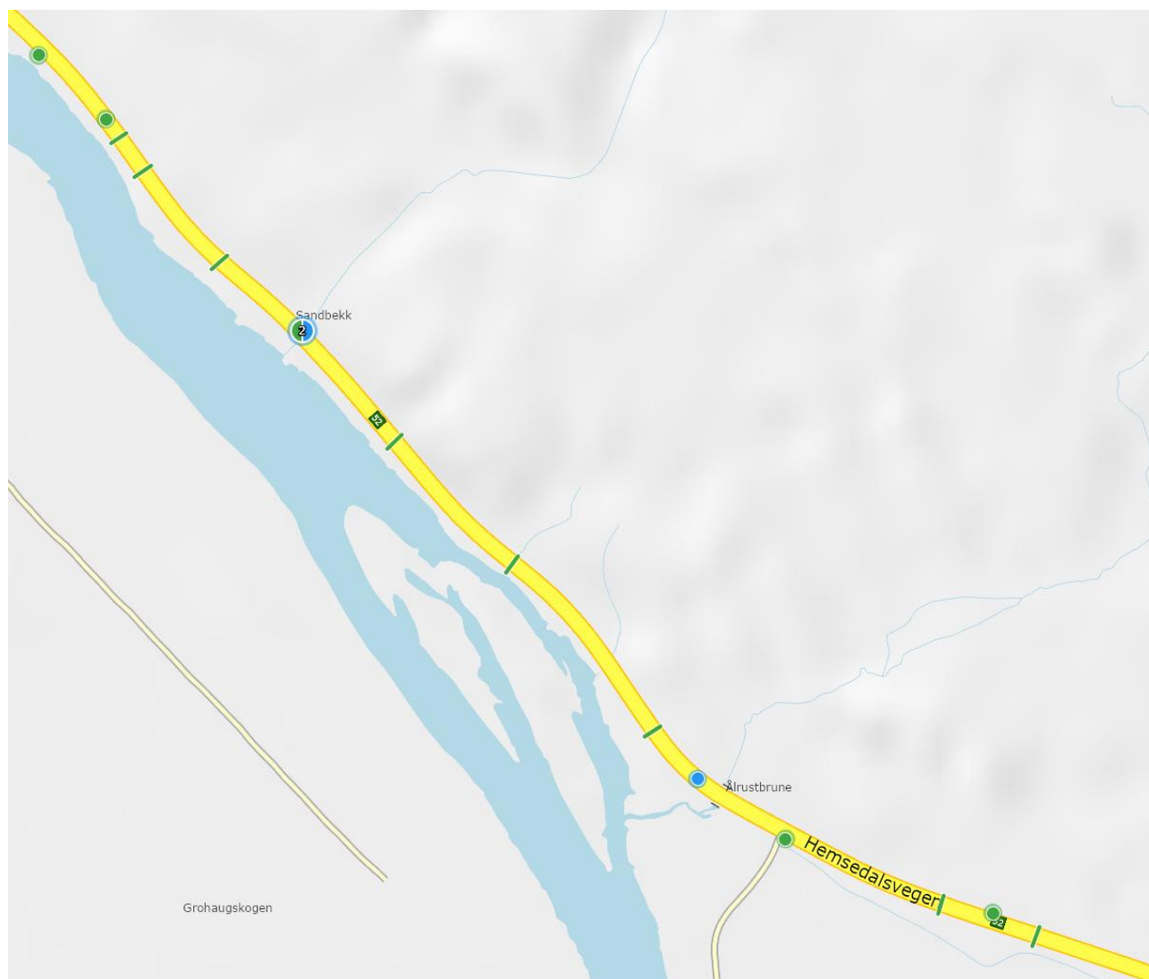
Figur 7. Stikkrenner og bruer registrert i Statens Vegvesen's vegkart ved Sandbekk og Ålrust bru. Stikkrenner er vist i grønt og bruer i blått. Dimensjoner er ikke registrert.
