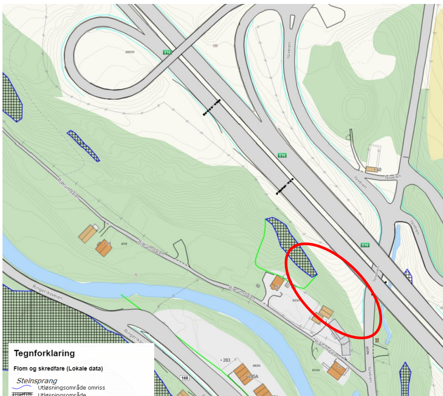
Figur 2-8 Skråning som viser steinsprangfare og området som ifm. befaring ble vurdert som svært bratt skråning, rød sirkel.
