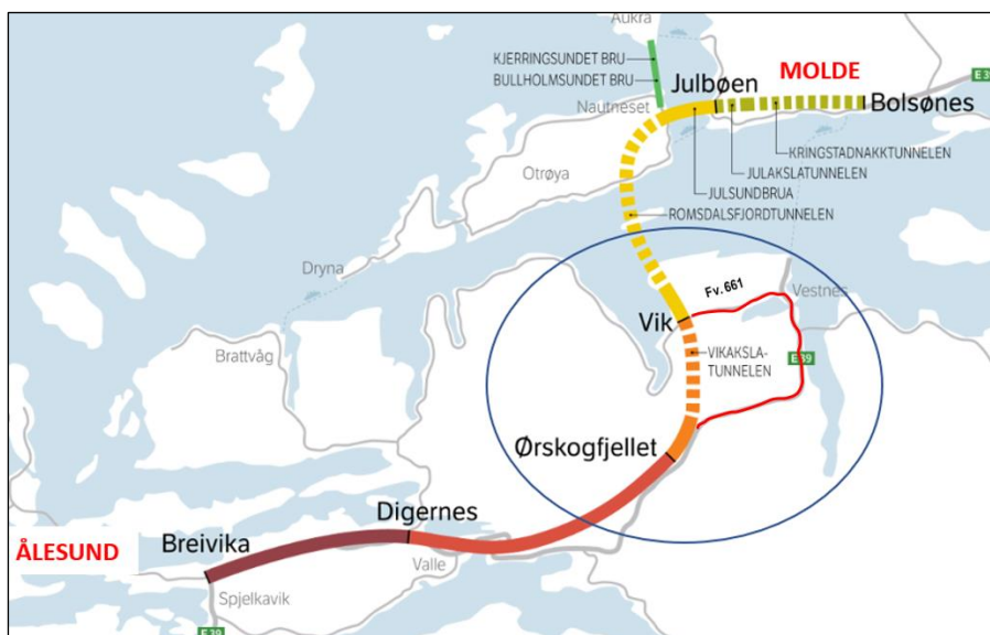
Figur 59 Kart viser ny E39 Ålesund- Molde der strekningen Ørskogfjellet- Vik følger eksisterende fv. 661 og dagens E39 til Ørskogfjellet. Dette er referansealternativet for denne reguleringsplanen.
