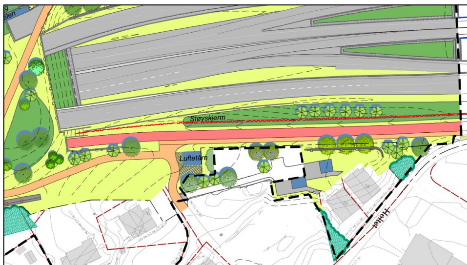
Figur 4-1 Utsnitt av O-tegningen ved Holtet 18 og 20. Svart tykk strek er støttemur med gjerde, hovedsykkelveg med fortau er vist rosafarget, gang-/sykkelveg med oransje farge og støyskjerm er vist med sammenhengende rød linje
