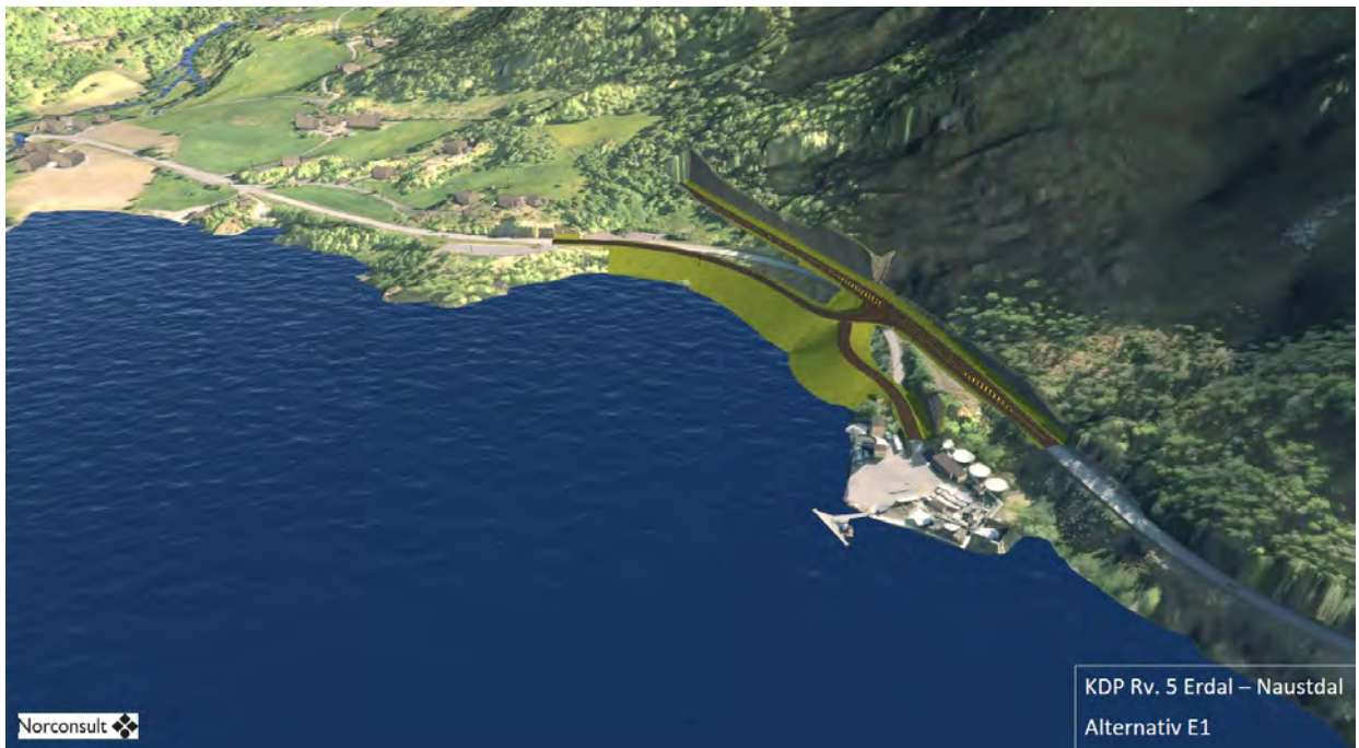
Figur 1-2 Illustrasjonen syner løysing ved tunnelpåhogget E1 i Erdal (tunnelportal og m.a. landskapstilpassing/planering syner ikkje på illustrasjonen.)
