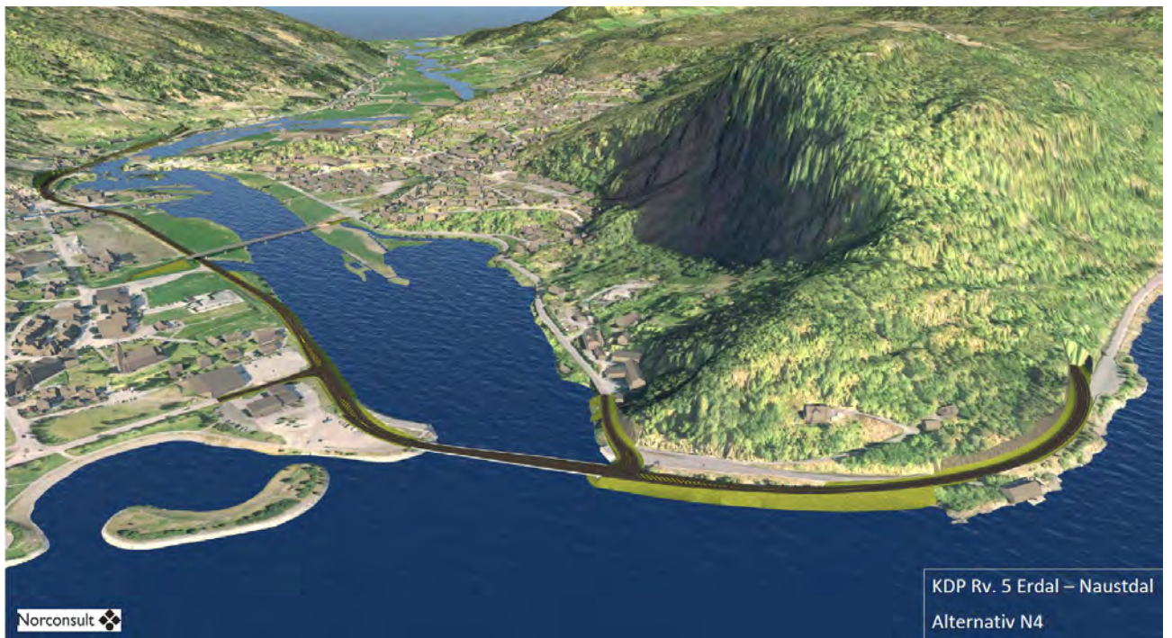
Figur 1-3 Illustrasjonen syner alternativ N4 ved Naustdalsneset. Ny riksveg kjem ut ved dagens rasteplass og kryssar elva på ny bru nedom dagens bru.
