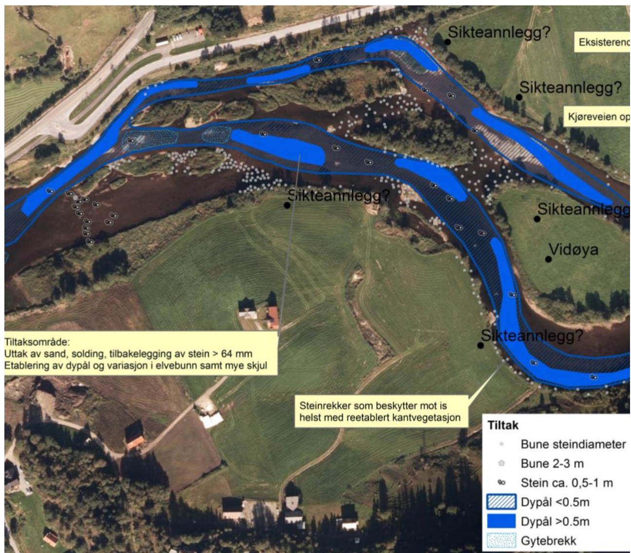
Figur 2. Del av plan over habitattiltaksområde ved Jonstad i 2017. En bune er halvterskler av utlagt storstein, en dypål er det dypeste løpet i elven og et gytebrekk er et område som egner seg for gyting mtp. steinstørrelse sikrer at eggene vil ligge trygt og riktig og med en vannstrøm som sikrer god oksygentilgang nede i grusen.
