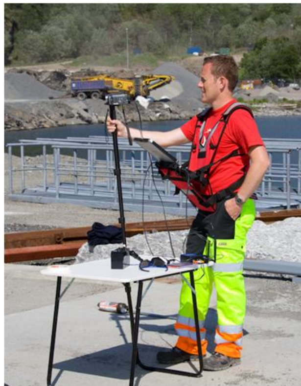
Bilde 3: PIMEX 2008 mottakerenhet (Fotograf Dag Steinar Tønder, Nordasfalt).
