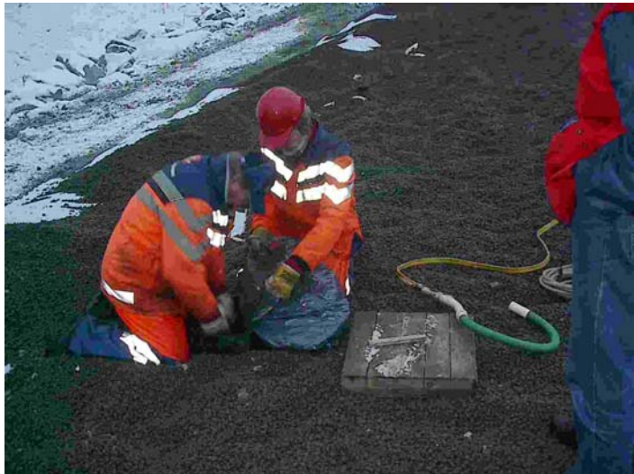
Figur 8: Prøvetaking av utlagt, komprimerte materiale.
