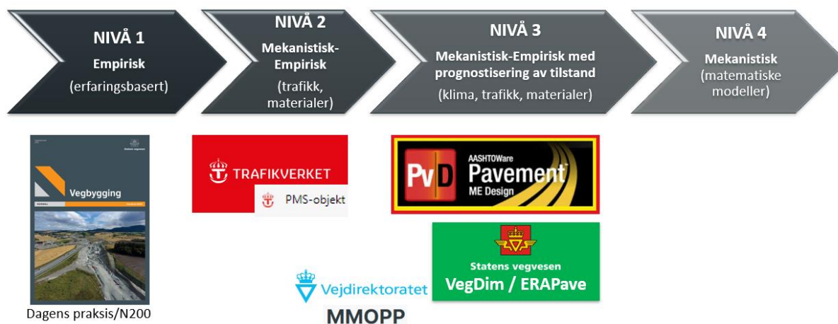
Figur 1: Illustrasjon over ulike nivå for dimensjonering av vegoverbygninger (Brynhild Snilsberg)
