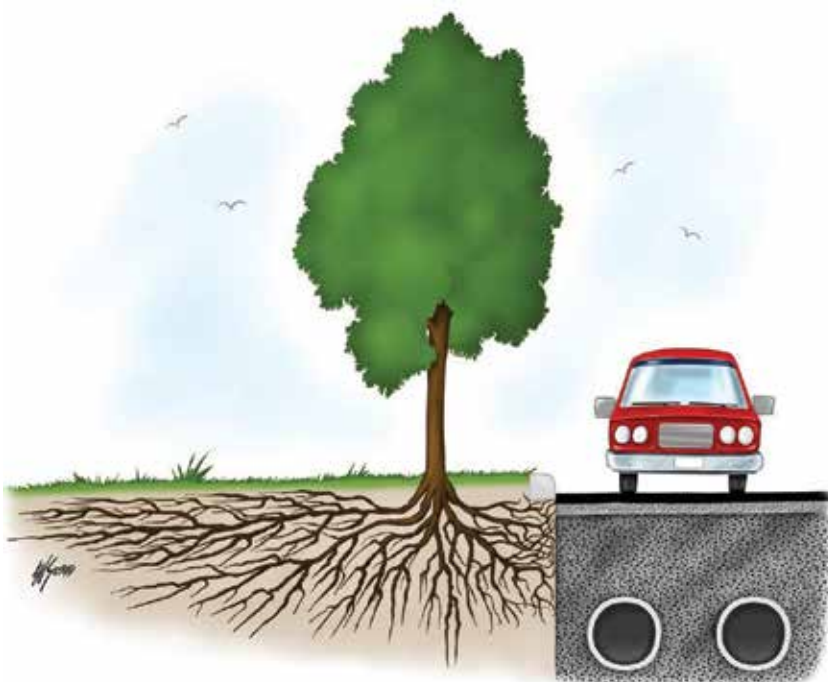
Figur 25 Bevaring av trær ved utbygging kan føre til at røttsystemet skades. Vi skal være klar over hvilke inngrep som gjøres i røttsonen og vurdere om det kan føre til at treet blir ustabil. illustrasjon: Arild W Solerød
