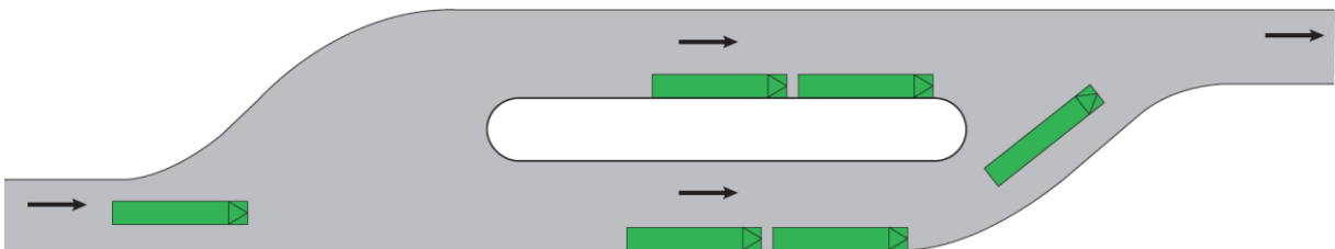
Figur 37 Langsgående oppstilling ved gjennomkjøringsknutepunkt
