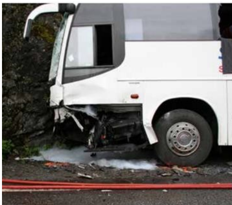
Bildet viser deformasjon på buss etter møteulykke med liten overlapp
