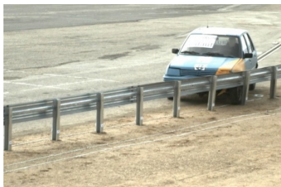
Test: TB11 (car 900 Kg., 100 Km/h., 20º)
