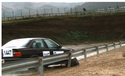
Test: TB32 (car 1.500 Kg., 110 Km/h., 20º)
