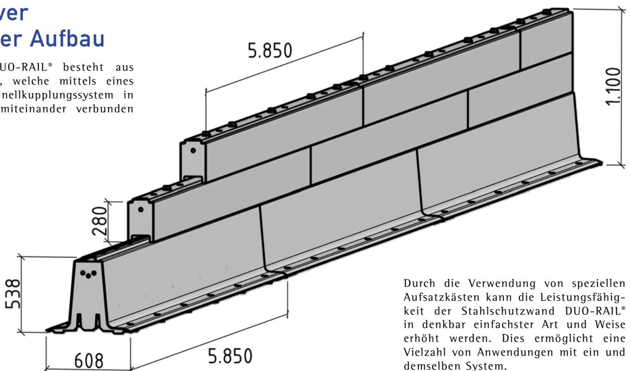
Durch die Verwendung von speziellen Aufsatzkästen kann die Leistungsfähigkeit der Stahlschutzwand DUO-RAIL® in denkbar einfachster Art und Weise erhöht werden. Dies ermöglicht eine Vielzahl von Anwendungen mit ein und demselben System.
