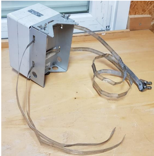
Figur 4. Armadillo der metallbåndene er tredd igjennom. Platen på toppen er skyvet halvveis ut.
