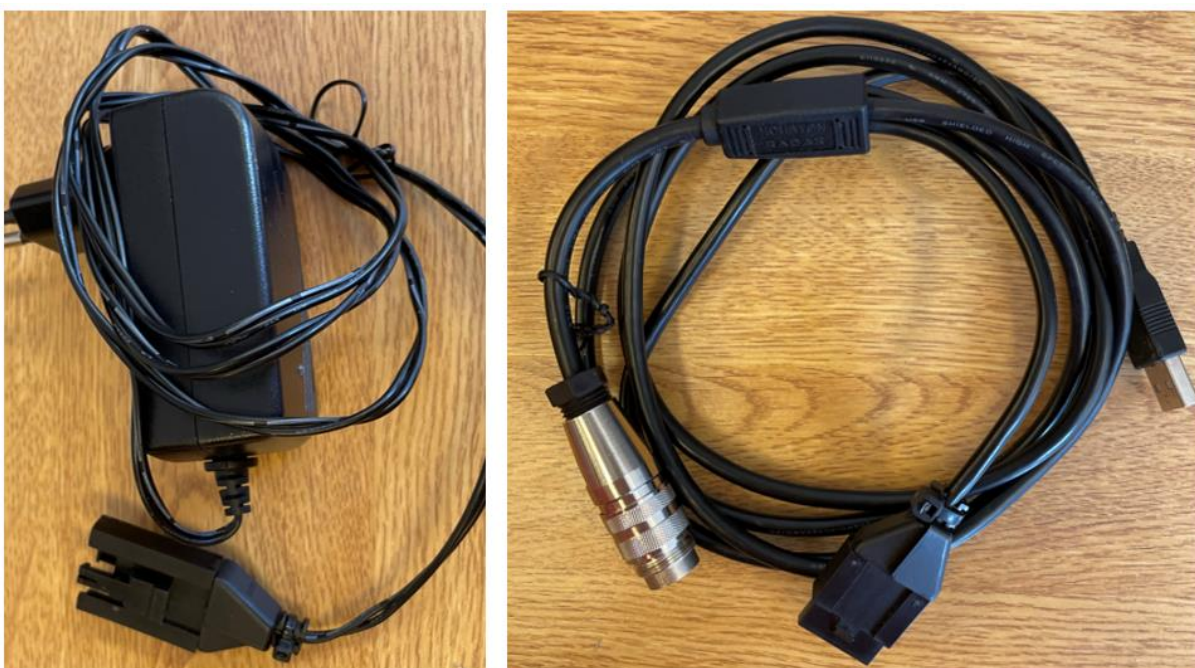
Figur 3. Lade- og kommunikasjonskabel med adapter.
