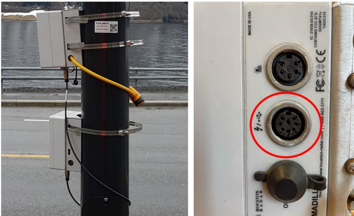
Figur 7. T.v. Armadillo med tilkoblet eksternt batteri. Armadilloen er sikret med et sykkellås. Det eksterne batteriet kan sikres på samme måte. T.h. Det eksterne batteriet kobles inn på den midterste porten på Armadilloen.
