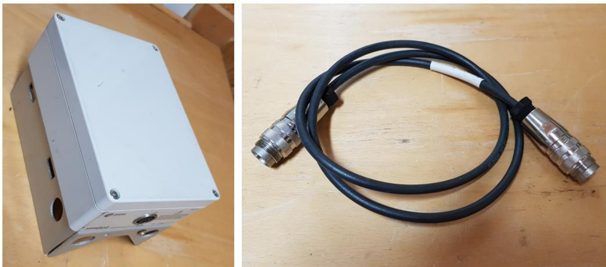
Figur 2. Ekstern batteripakke og batterikabel.
