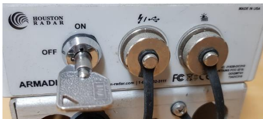
Figur 5. Medfølgende nøkkel brukes for å skru på Armadilloen.
