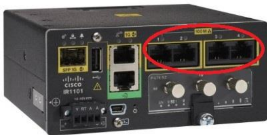
Figur 7. IR1101-ruter. Kommunikasjonskabelen kobles inn på en av portene innenfor den røde sirkelen (1-4).
