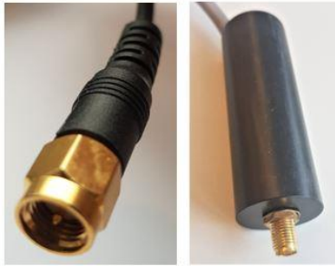
Figur 12. Til venstre vises pluggen fra GNSS-antenne sin ledning. Den skal kobles til pluggen på GNSS-kabelen som er vist til høyre.
