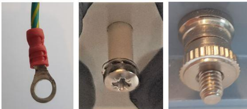
Figur 13. Til venstre vises enden av jordingsledningen. I midten viser jordingspunktet til CMU og til høyre vises jordingspunktet til «piezo interface connector» der jordingsledningene skal kobles på.
