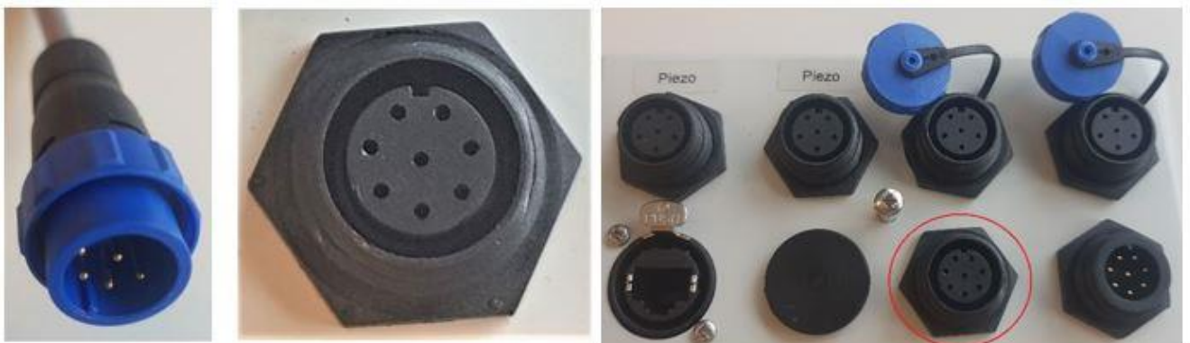
Figur 11. Til venstre vises pluggen på GNSS-kabelen, i midten vises porten på CMU der GNSS-kabelen skal kobles på, og til høyre er denne porten ringet inn.
