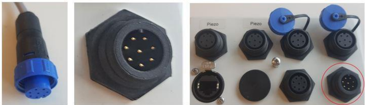
Figur 16. Til venstre vises pluggen på strømkabelen, i midten vises porten på CMU der strømkabelen skal kobles på, og til høyre er denne porten ringet inn.
