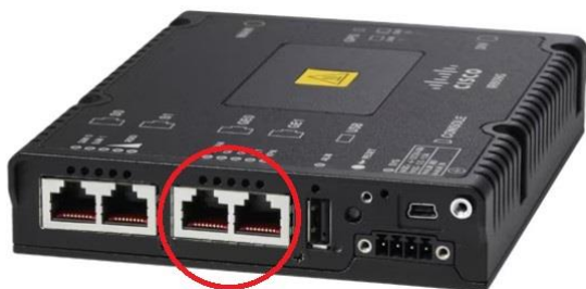
Figur 8. Cisco 809-ruter. Kommunikasjonskabelen kobles inn på en av portene innenfor den røde sirkelen (GE0 eller GE1).
