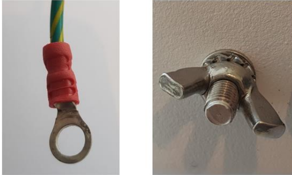
Figur 15. Til venstre vises enden av jordingsledningen og til høyre vises jordingspunkt på Dr7 OPCUA der jordingsledningen skal kobles på.
