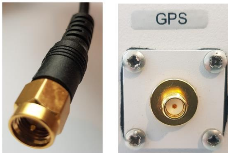
Figur 14. Til venstre vises pluggen av GNSS-ledningen og til høyre vises porten på Dr7 OPCUA der GNSS-ledningen skal kobles på.
