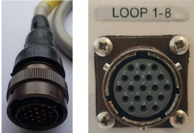
Figur 8. Til venstre vises pluggen på sensorkabelen og til høyre vises porten på Dr7 OPCUA der sensorkabelen skal kobles på.
