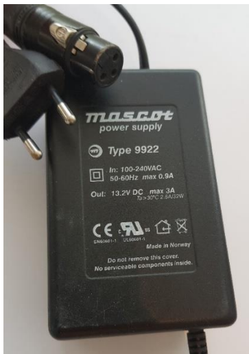
Figur 21. Strømforsyning med plugg for å koble strømkabelen til Dr7 OPCUA (Figur 16).
