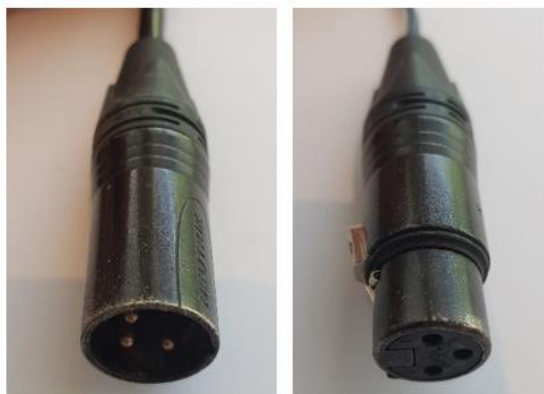
Figur 22. Bilde til venstre viser plugg (XLR3M) på strømkabelen til Dr7 OPCUA. Bilde til høyre viser plugg (XLR3M) fra strømforsyning eller batterilader.
