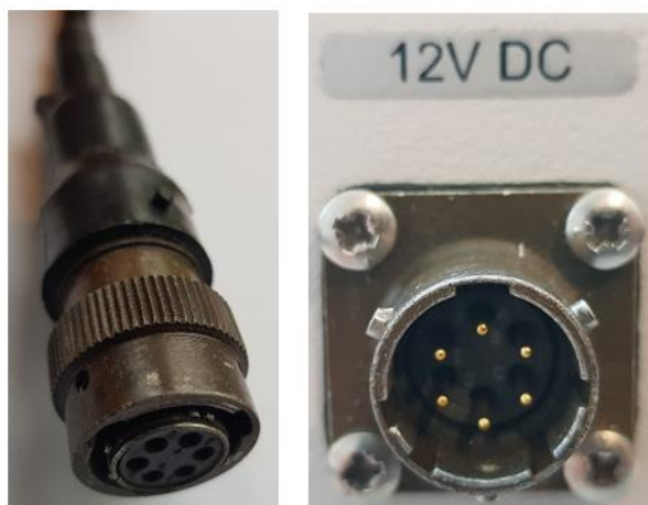
Figur 17. Til venstre vises pluggen på strømkabelen og til høyre vises porten på Dr7 OPCUA sykkel der strømkabelen skal kobles på.
