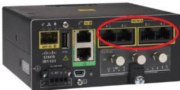
Figur 11. IR1101-ruter. Kommunikasjonskabelen kobles inn på en av portene innenfor den røde sirkelen (1-4).
