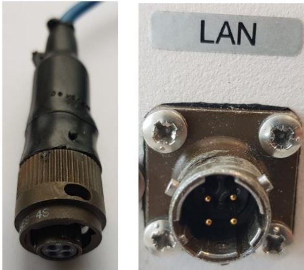
Figur 13. Til venstre vises pluggen på kommunikationskabelen og til høyre vises porten på Dr7 OPCUA sykkel der kommunikationskabelen skal kobles på.
