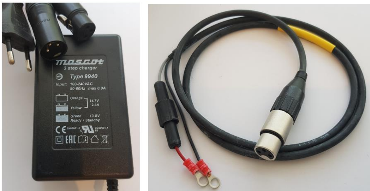
Figur 19. Bilde til venstre viser batterilader med to plugger for å koble på strømkabelen til Dr7 OPCUA sykkel (Figur 16) og kabelen til reservebatteri (bilde til høyre).
