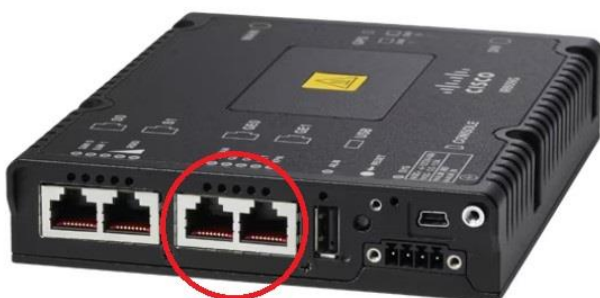
Figur 12. Cisco 809-ruter. Kommunikasjonskabelen kobles inn på en av portene innenfor den røde sirkelen (GE0 eller GE1).
