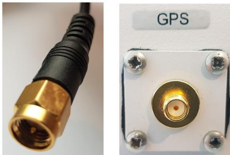
Figur 14. Til venstre vises pluggen av GNSS-ledningen og til høyre vises porten på Dr7 OPCUA sykkel der GNSS-ledningen skal kobles på.
