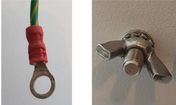
Figur 15. Til venstre vises enden av jordingsledningen og til høyre vises jordingspunkt på Dr7 OPCUA sykkel der jordingsledningen skal kobles på.
