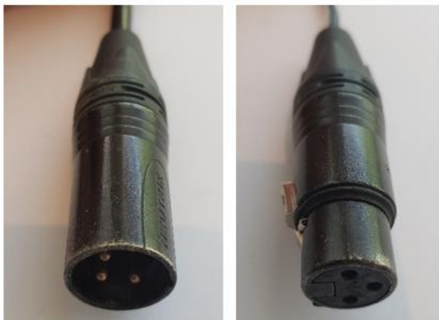
Figur 22. Bilde til venstre viser plugg (XLR3M) på strømkabelen til Dr7 OPCUA sykkel. Bilde til høyre viser plugg (XLR3F) fra strømforsyning eller batterilader.
