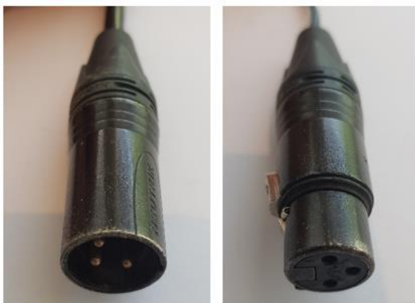
Figur 22. Bilde til venstre viser plugg (XLR3M) på strømkabelen til Loop Monitor sykkel. Bilde til høyre viser plugg (XLR3F) fra strømforstyring eller batterilader.
