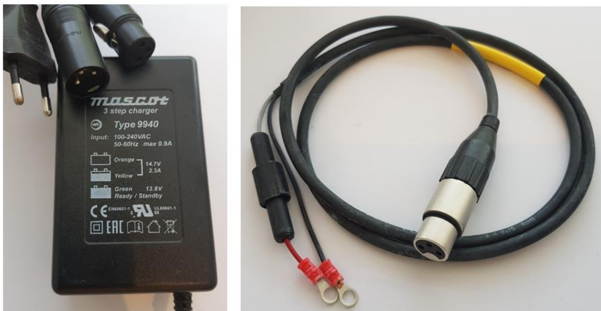
Figur 19. Bilde til venstre viser batterilader med to plugger for å koble på strømkabelen til Loop Monitor sykkel (Figur 16) og kabelen til reservebatteri (bilde til høyre).
