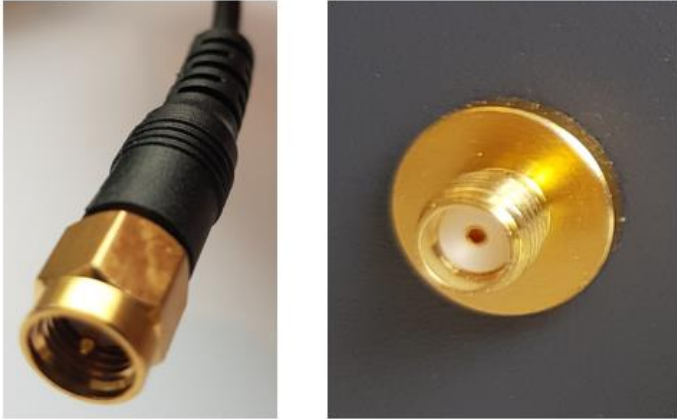
Figur 14. Til venstre vises pluggen av GNSS-ledningen og til høyre vises porten på Loop Monitor der GNSS-ledningen skal kobles på.
