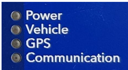
Figur 23. Nærbilde av lysdiodene.
