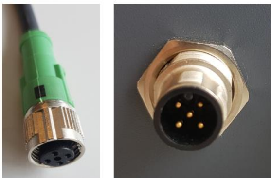
Figur 17. Til venstre vises pluggen på strømkabelen og til høyre vises porten på Loop Monitor der strømkabelen skal kobles på.
