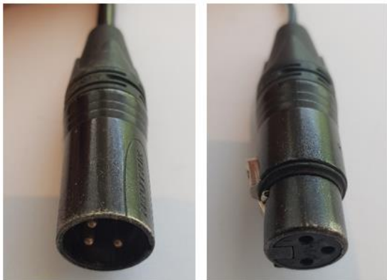
Figur 22. Bilde til venstre viser plugg (XLR3M) på strømkabelen til Loop Monitor. Bilde til høyre viser plugg (XLR3F) fra strømforsyning eller batterilader.
