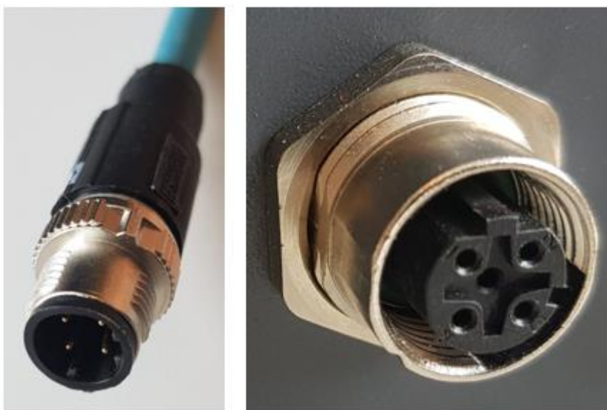
Figur 13. Til venstre vises pluggen på kommunikasjonskabelen og til høyre vises porten på Loop Monitor der kommunikasjonskabelen skal kobles på.
