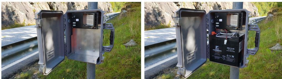
Figur 10. Plassering av batteri i Topo.
