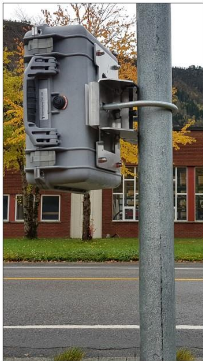
Figur 17. For liten vinkel på Topo gir kortere kjøretøy.
