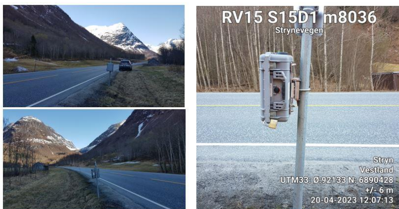
Figur 18. Eksempler på bilder som dokumenterer hvilken side av veien Topo er montert, og i hvilken retning den peker. Bildet til høyre er tatt med appen "Vegviseren".
