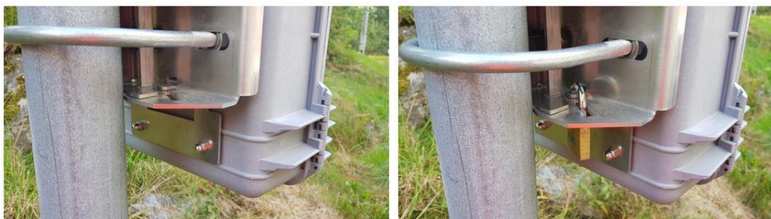
Figur 13. Låse Topo til brakett med hengellås.
