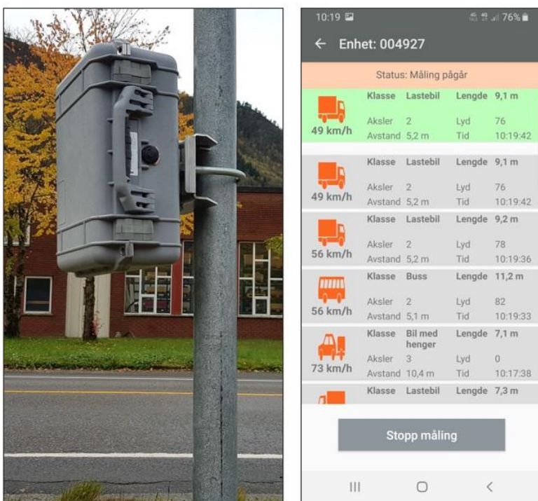
Figur 16. For stor vinkel på Topo gir lenger kjøretøy.
