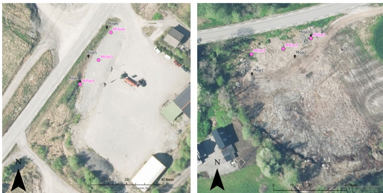
Figur 6: Planlagde prøvepunkt i rosa, endelege prøvepunkt i svart. Prøvetaking ved «Tanken» til venstre, ved fyllingsområde på Tveit til høyre. Noko praktisk tilpassing i felt måtte gjerast og det er difor tenkt at prøvetaking i Miljø 1 og 2 svarte punkt gjeld for Miljø 1 og 2 rosa punkt.
