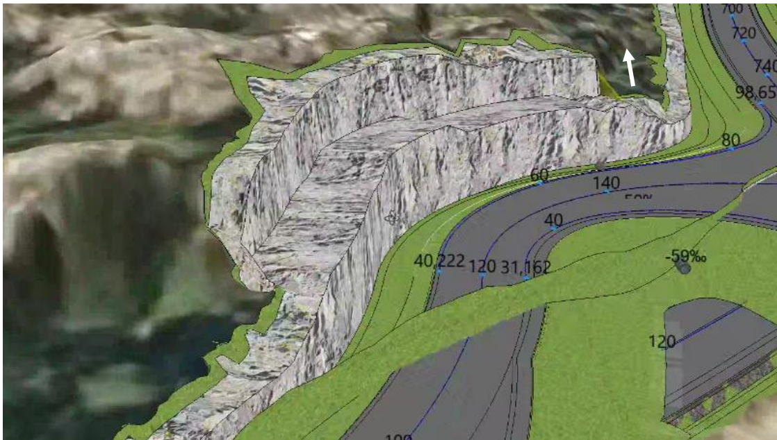
Figur 38: Illustrasjon fra vegmodell som viser berghyller med varierende høyde. Bildet er tatt inne fra kommunal veg Seterdalen, E6 opp i høyre hjørne.
