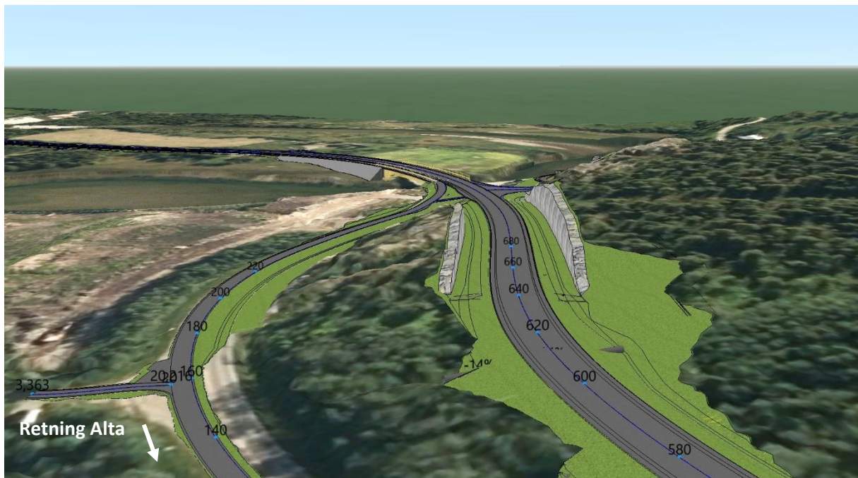
Figur 9: Nærbilde som viser ny trasé for E6 gjennom tosidig bergskjæring til høyre og fremtidig gang-/sykkelveg i dagens vegtrasé til venstre.
