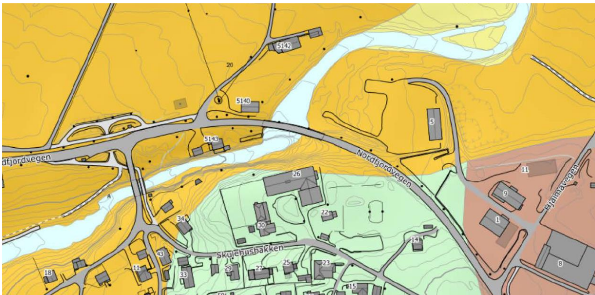
Figur 17 Kartutsnitt NGU.no. Dei orangerfarga felta er breelvavsetningar, i hovudsak grusige massar.. Det som ikkje kjem fram på kartet er dei mange bergblotningane i området. Berget ligg generelt høgt. Til dømes er eksisterande bru direktefundamentert på berg.
