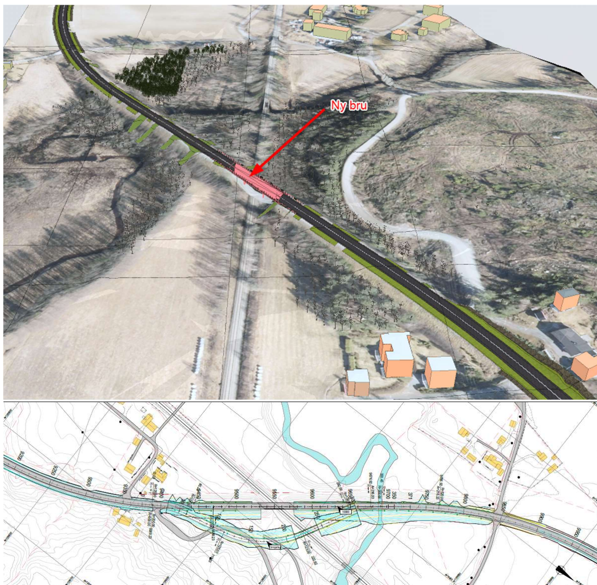
Figur 1. 3D-modell over ny bru og utvidelse av veibanen (øverst), og plantegning med interimvei (nederst).
