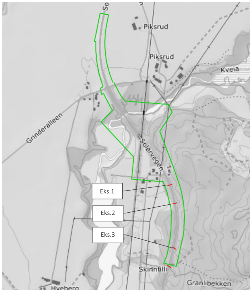
Figur 5 Eksisterende stikkrenner (rødt) med planavgrensning (grønt) (Scalگو/Vegkart)
