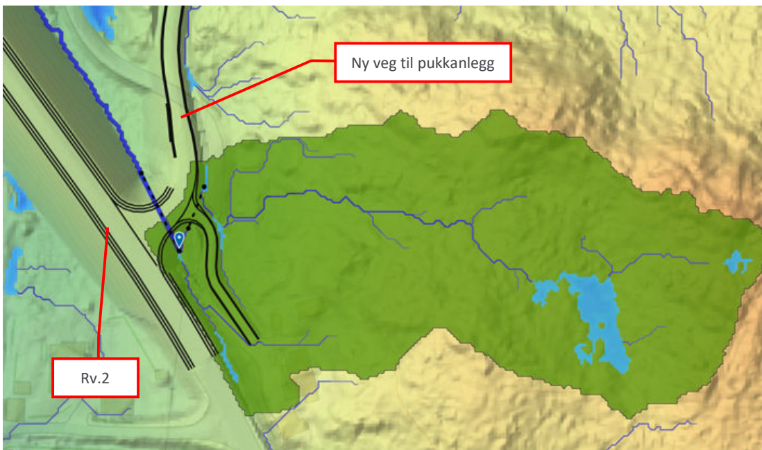
Figur 11 Nedslagsfelt for stikkrenner 1 og 2
