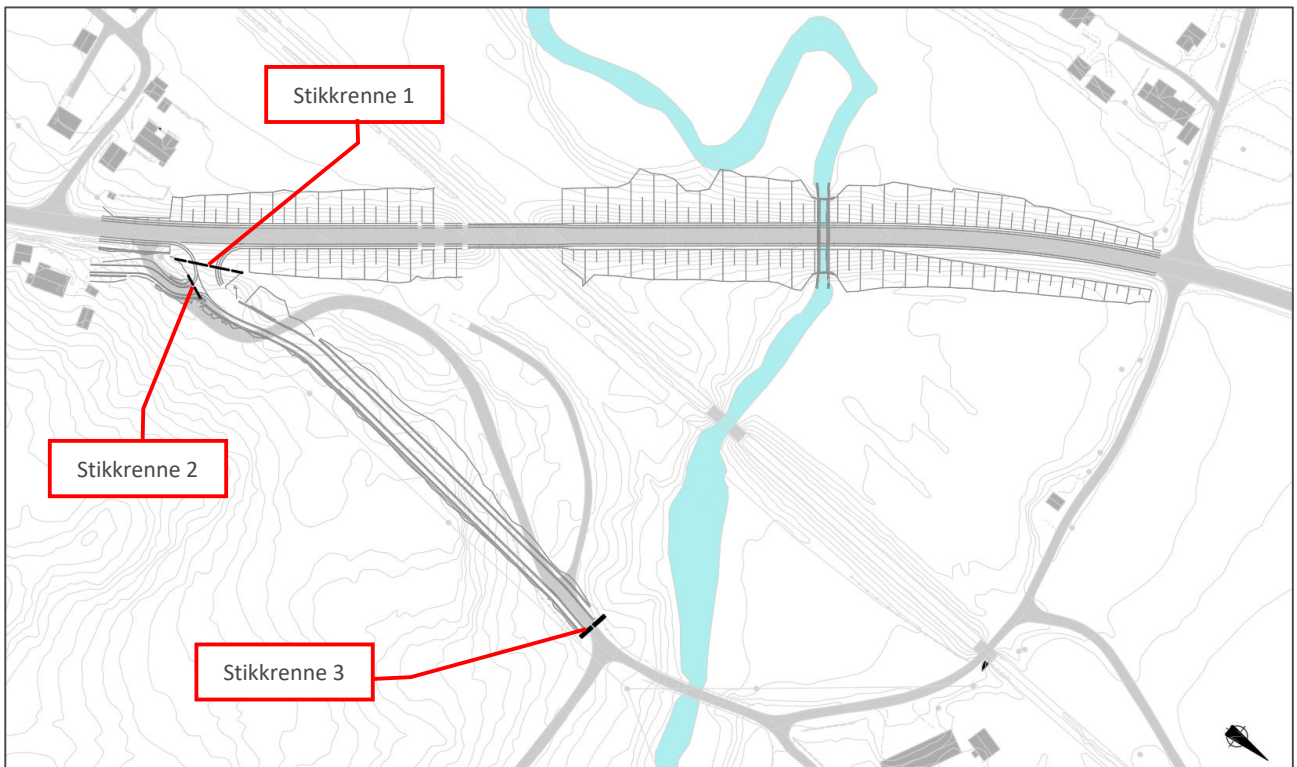
Figur 10 Etablering av nye stikkrenner ifm. ny vei til pukkanlegg
