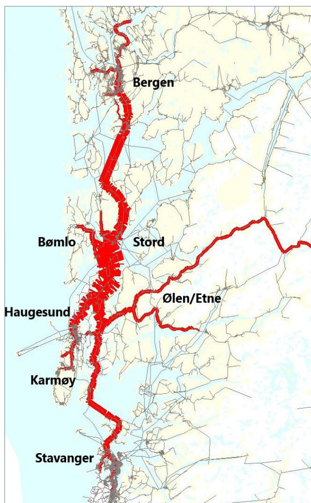
Figur 10: Fordeling av trafikk som passerar gjennom Bømlafjordtunnelen (RTM Basis 2020, Statens vegvesen)
