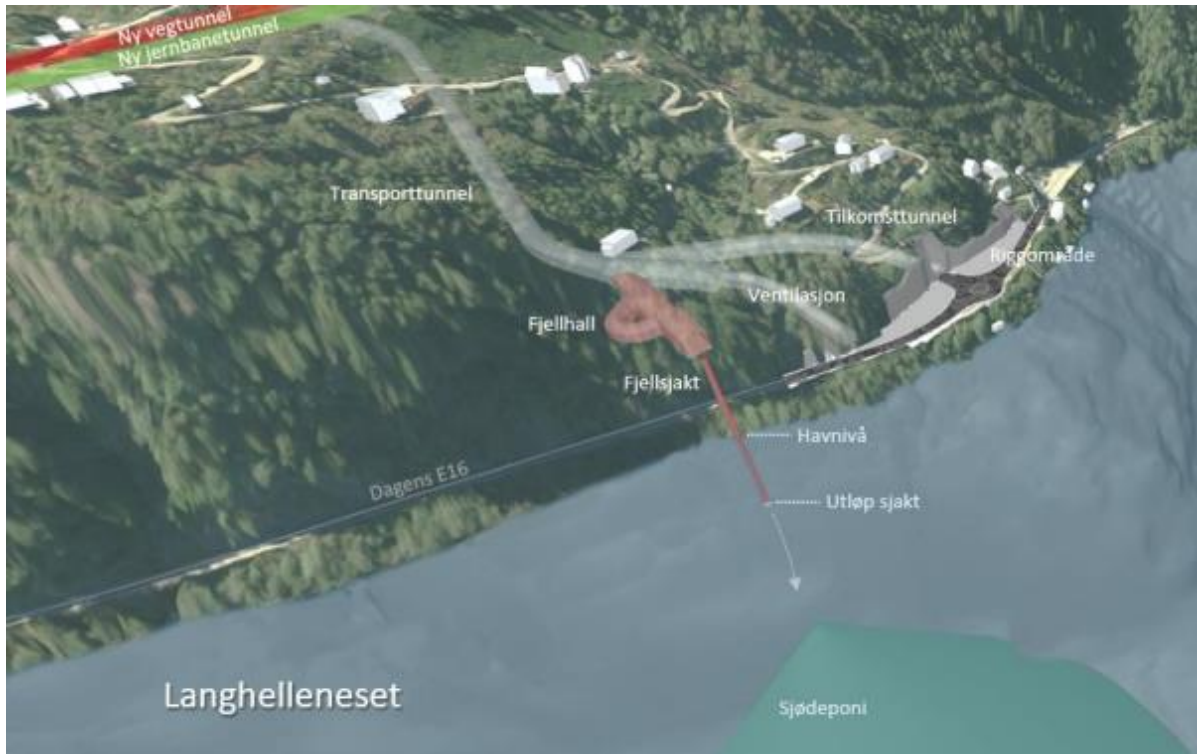
Figur 3-2: Illustrasjonen viser løsning med skråstilt fjellsjakt for nedføring av stein til sjødeponi ved Langhelleneset. (Kilde: FAS)
