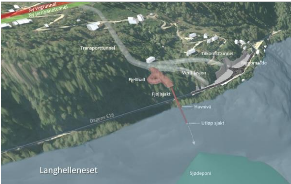
Figur 6-3 Ny løsning for nedføring av masser ved Langhelleneset (Kilde: FAS)
